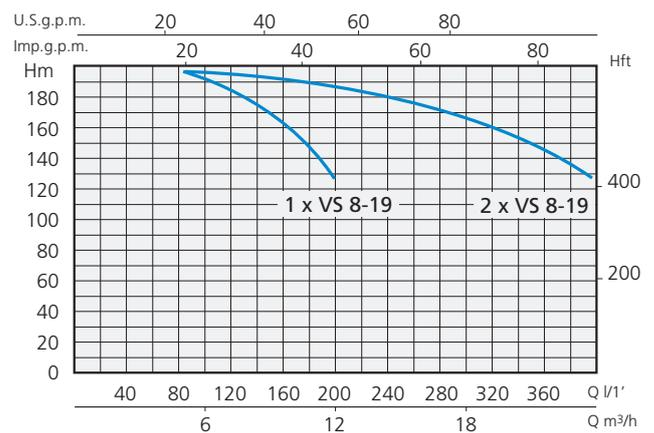
Gruppo di pressione con 2 pompe verticali multistadio acciaio inox completo di basamento con antivibranti, collettore di aspirazione e di mandata, valvola a sfera, valvola di non ritorno, con o senza 2 serbatoi a membrana.
